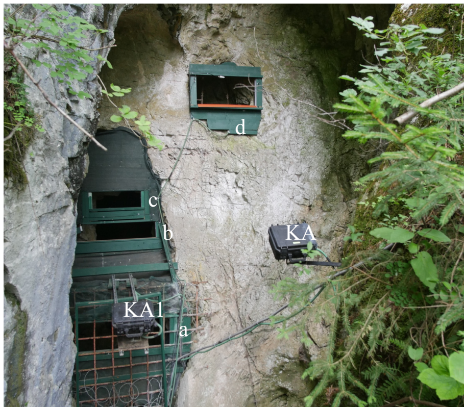
Abb.1. Position der vier Lichtschranken (a – d) und der beiden Ausflugskameras (KA, KA1). Die beiden Einflugskameras befinden sich im Inneren der Höhle.
